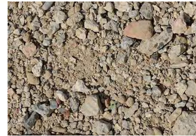
Figure 212 : Exemple de revêtement GNT 0/60
