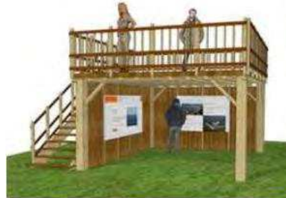
Figure 237 : Exemple de belvédère en bois
